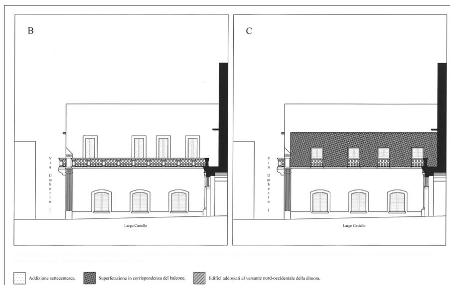
Fig. 4B-C; . Prospetto laterale dell’avancorpo sinistro (stato originario); C. Prospetto laterale dell’avancorpo sinistro (stato di fatto).
